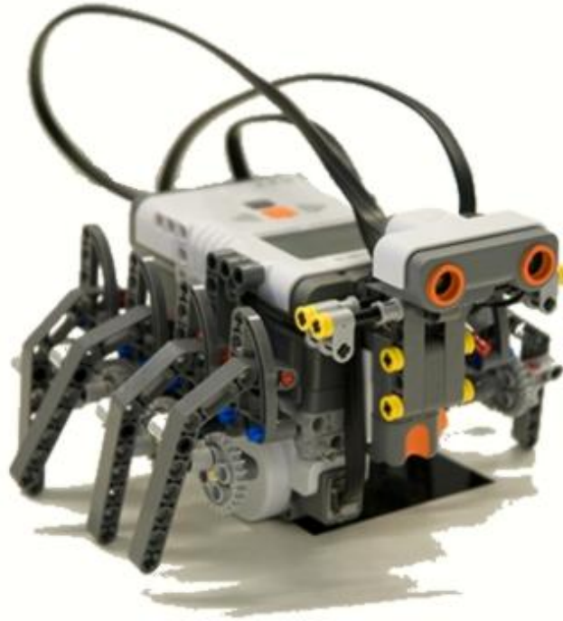
Слика 2.2.1 Пример хексаподне конфигурације
