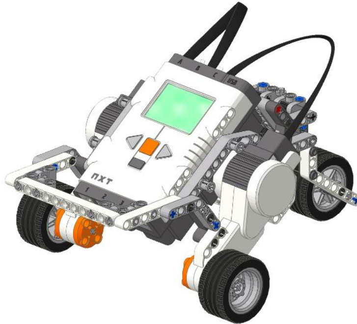
Слика 2.2.3 Конфигурација са два точка и задњим ослонцем
